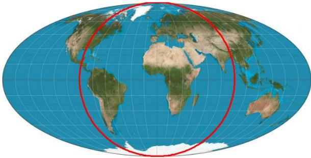
Ellipse entspricht der Oberfläche einer Kugel mit Radius  $R$ ; für die Punkt-Koordinaten gilt:  $-2\sqrt{2} \cdot R \leq x \leq 2\sqrt{2} \cdot R$  und  $-\sqrt{2} \cdot R \leq y \leq \sqrt{2} \cdot R$ . Die Darstellung der Erde in der MOLLWEIDE-Projektion wird auch heute noch verwendet, insbesondere wenn Übersichten hinsichtlich der Vegetation oder des Klimas erfolgen sollen.
